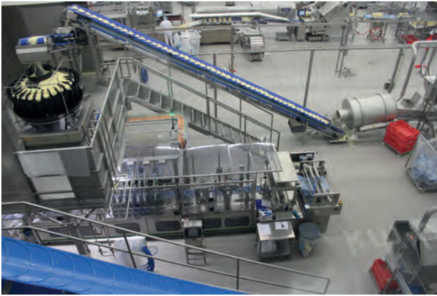
Die neue Linie produziert, verpackt und kennzeichnet 100 Beutel Reibekäse pro Minute.
